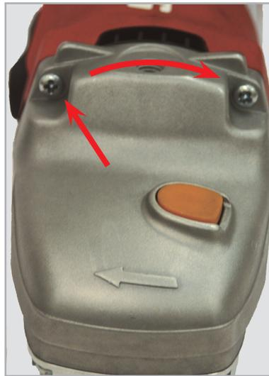
Die vier Schrauben entfernen und den Getriebekopf vorsichtig in die gewünschte Lage drehen. Dabei darauf achten, dass er nicht mehr als 1 mm vom Motorgehäuse abhebt. Die Schrauben wieder eindrehen und festziehen.
