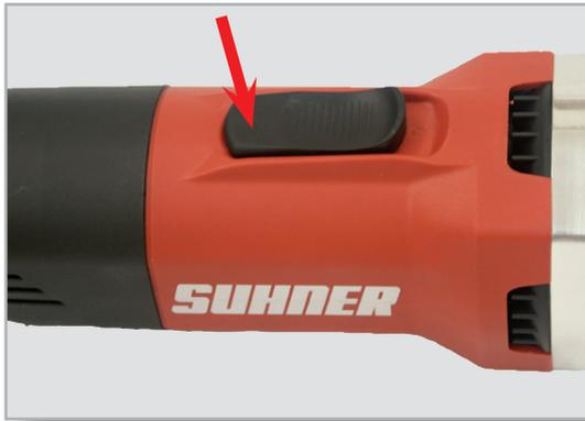
Premendo l'interruttore ACCESO/SPENTO viene sbloccato il fermo e la macchina si arresta.
