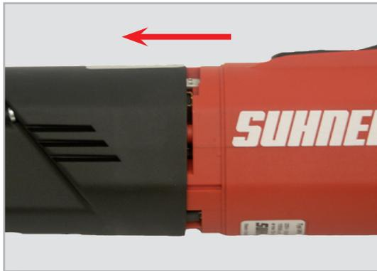
Schrauben lösen und Deckel entfernen.
