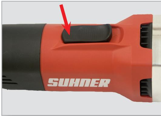
Durch Drücken des EIN-/AUS-Schalters wird die Arretierung gelöst und die Maschine stellt ab.
