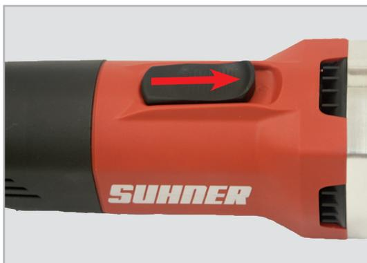
Schalter muss in der AUS-Position sein, d.h. die «0» ist sichtbar. Um die
